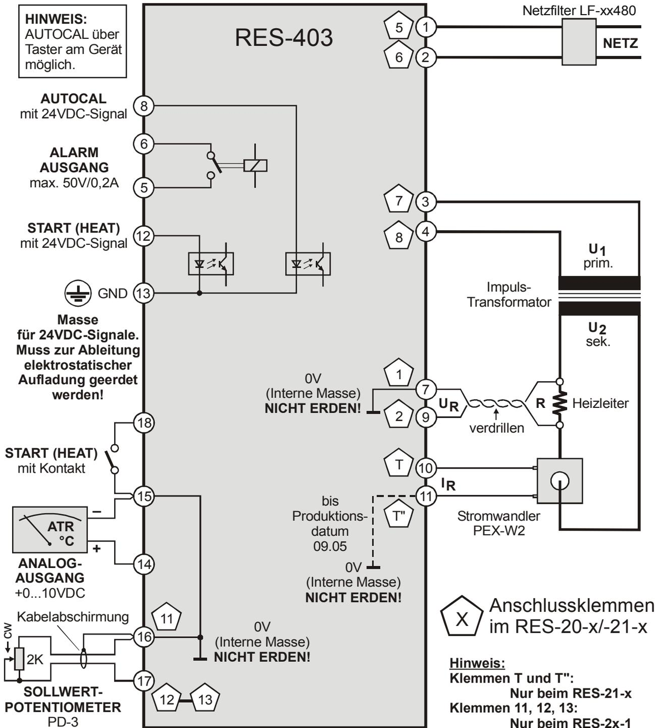
**⚠** Beim RES-403 kann das START-Signal nur über Kontakt (Klemmen 15+18) oder 24VDC Gleichspannung (Klemmen 12+13) aktiviert werden. 24VAC Wechselspannung führen zur Beschädigung des Reglers und darf nicht verwendet werden.
