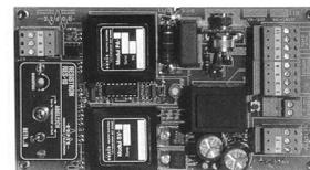
Der RESISTRON-Temperaturregler RES-403 kann als Ersatzgerät für den Regler RES-11 verwendet werden. Im folgenden werden die bei der Umrüstung von RES-11 auf RES-403 notwendigen Maßnahmen erläutert.
